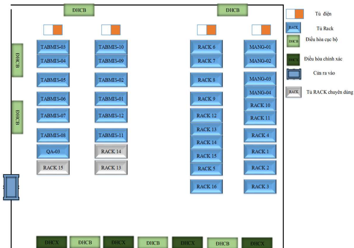
Sơ đồ mặt bằng bố trí thiết bị phòng máy chủ số 1
